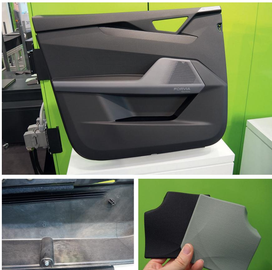
**Bild 4.** Kunststoff, Farbe und Abformung in einem keramikbeschichteten Werkzeug ergeben eine zum Teil textile Anmutung (rechts). Verschiedene Texturen können in einem Bauteil kombiniert werden (oben), nur die Rückseite (links) zeigt die Oberflächendefekte vom Schäumen. © Hanser/C. Doriat
